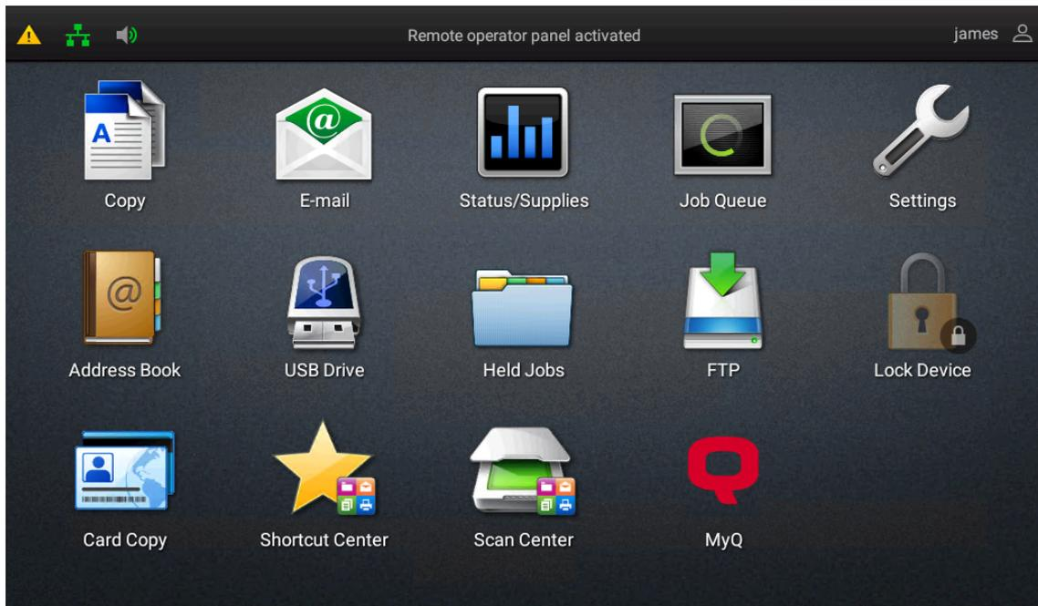
Pour revenir au menu principal, il est possible d'utiliser l'icône MyQ sur le panneau de l'appareil. Pour se déconnecter du panneau natif, l'utilisateur doit appuyer sur le nom d'utilisateur dans le coin supérieur droit.
