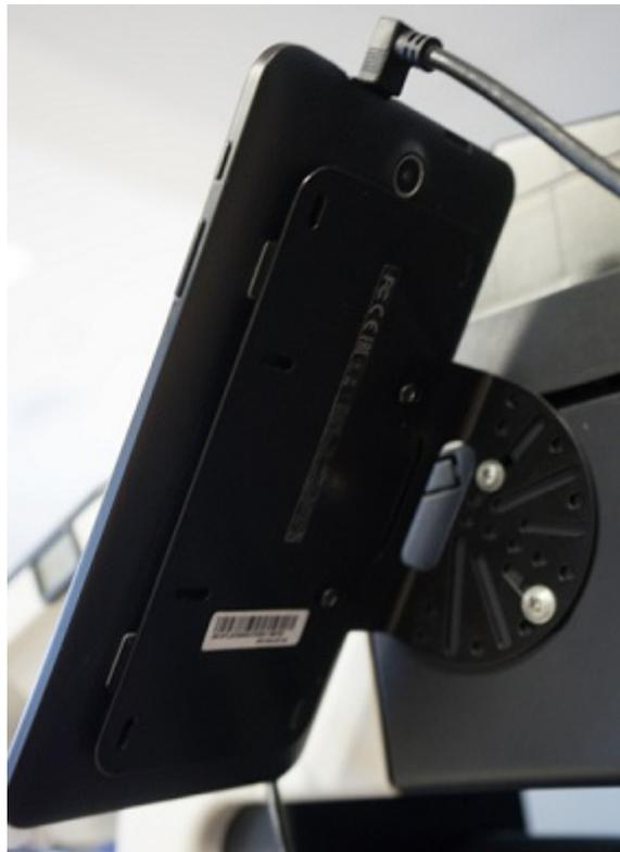
Il est recommandé de tenir le MyQ Touch Panel verticalement et de fixer le support de tablette sur le côté long (côté gauche ou droit). Si vous souhaitez le tenir horizontalement, il est recommandé de le fixer sur le côté long (côté supérieur ou inférieur) pour assurer sa stabilité.
