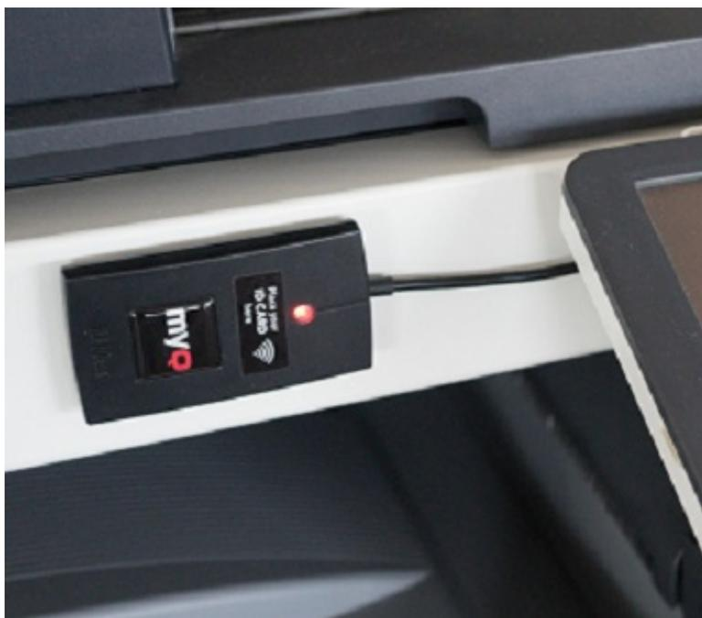
Vous pouvez également le fixer au dispositif d'impression ou à l'écran tactile MyQ à l'aide du support TRH. La conception du support TRH offre la possibilité d'utiliser certains des trous existants du dispositif d'impression.
