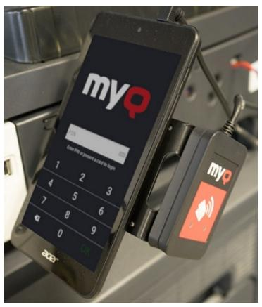
El lector de tarjetas se conecta al terminal a través de un cable USB y se detecta automáticamente después de enchufarlo.
